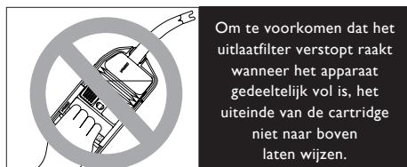
Het inlaatventiel (uiteinde van de cartridge) is speciaal ontworpen om te voorkomen dat er opgezogen materiaal terugstroomt wanneer het uiteinde van de cartridge naar beneden wijst.
