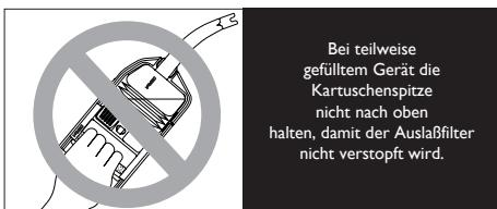
Das Einlaßventil (Kartuschen spitze) ist so ausgelegt, daß kein aspiriertes Material durch die Spitze zurücklaufen kann, solange die Kartuschen spitze nach unten weist.
