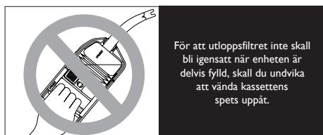
Inloppsventilen (kassettspetsen) är konstruerad för att hindra returflöde av uppsuget material genom spetsen när den vänds nedåt.
