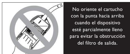
La válvula de entrada (punta del cartucho) fue diseñada para impedir que la materia succionada fluya de vuelta a través de la punta del cartucho cuando ésta apunte hacia abajo.
